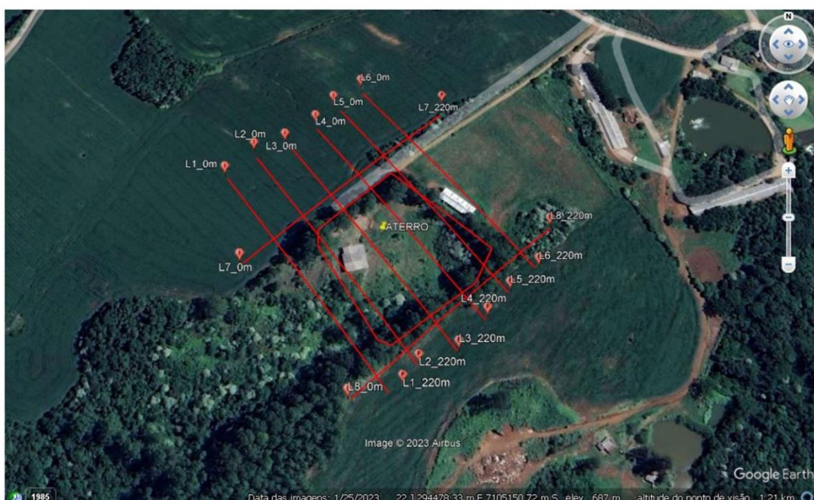
Figura 1 – Proposta de localização das linhas geofísicas L1, L2, L3, L4 L5, L6, L7 e L8 na área do transbordo, na área rural, no município de Marmeleiro – PR FONTE: GOOGLE EARTH - 2023
